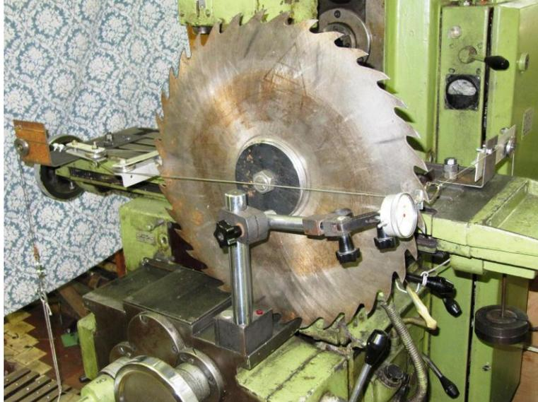
Рис. 4. Общий вид экспериментальной установки для исследования рабочей жесткости круглой пилы
