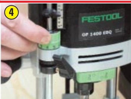
Если операция требует точности, хороший фрезер позволяет скорректировать установленное значение глубины. Его изменяют, не ослабляя (чтобы не сбить) фиксации опорной штанги, а вращая регулировочное колесико. Это можно сделать заранее, добившись точного совпадения рисок указателя и шкалы, или после пробного прохода.
