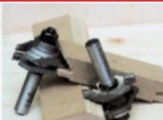
Одна из фрез (профиль) формирует кромку детали; парной (контрпрофиль) «проходит» торец сопрягаемой заготовки.
