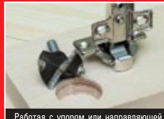
Работая с упором или направляющей и используя специальную фрезу, делают пазы для установки мебельных петель. Для точного продольного позиционирования отверстий можно воспользоваться специальной шиной, позволяющей жестко фиксировать положение фрезера через стандартные промежутки длины.
