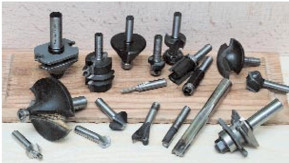
**Ф**резерование – обработка резанием металлов и неметаллических материалов, при которой режущий инструмент – фреза – имеет вращательное движение, а обрабатываемая заготовка – поступательное. Применяется для обработки плоскостей, криволинейных поверхностей деталей, резьбовых поверхностей, зубьев зубчатых и червячных колес и т.д. Осуществляется на фрезерных станках...
