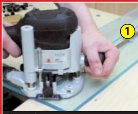
Подошву фрезера жестко привинчивают к «циркулю»; радиус задают перемещением по направляющей «центру». Центрирующий штифт вставляют в просверленное в заготовке отверстие. Существуют конструкции, в которых «циркулем» служит боковой упор или дополнительное приспособление, устанавливаемое на штангах.
