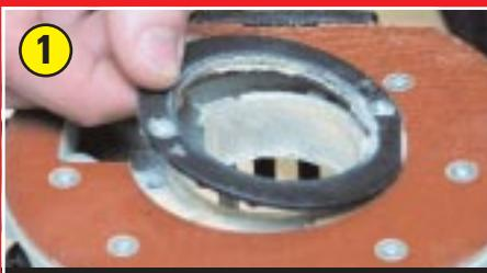
Для точной и удобной работы фрезер должен иметь гладкую подошву. Когда копировальная втулка не используется, паз, предназначенный для нее, закрывают кольцом. Перед установкой «копира» кольцо вынимают.
