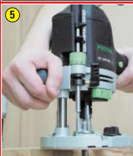
При опускании «головы» фреза войдет в заготовку на глубину, выставленную на откалиброванной шкале.
