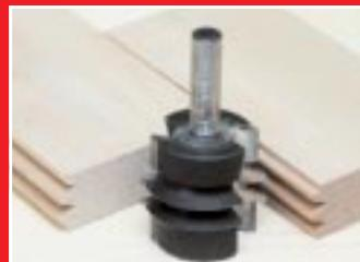
Некоторые шипованные соединения получают при помощи одной фрезы (контрпрофиль не нужен).
