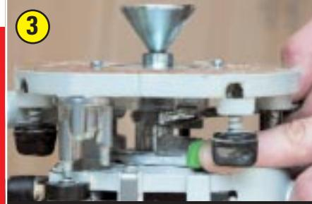
Для точного позиционирования втулки устанавливают центрирующий конус. Его, как обычную фрезу, зажимают в цангу (с той лишь разницей, что опорная подошва при этом прижата к корпусу).
