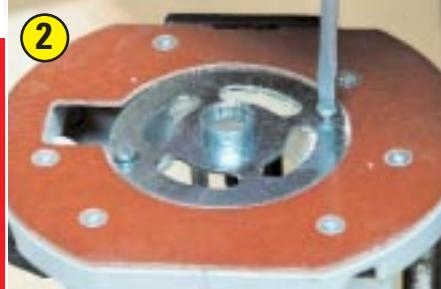
Подобрав втулку с нужным диаметром опорного кольца, ее привинчивают, но крепежные винты не затягивают.
