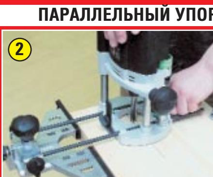
Фрезер устанавливают на линию разметки, упор подводят к кромке и фиксируют. В данном случае обе штанги зажимают вращением одной рукоятки, обычно — несколькими «персональными» винтами.
