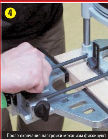
После окончания настройки механизм фиксируют.
