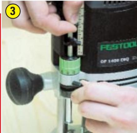
Штангу поднимают до совпадения указателя с требуемым делением измерительной шкалы и зажимают ее фиксатором.
