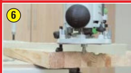
Если шаблон дает надежную опору только одной из сторон платформы, с другой выдвигают и фиксируют стопорным винтом дополнительную «подпорку». Если этого не сделать, велик риск проиграть в точности.
