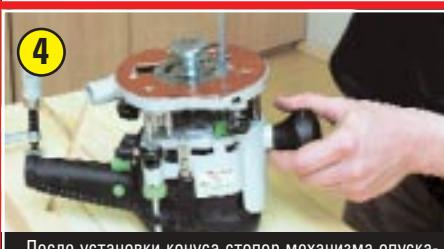
После установки конуса стопор механизма опускания освобождают, и подошва под действием подъемных пружин прижимает конус к втулке, тем самым точно центрируя ее. Вновь зафиксировав стопор, винты крепления втулки надежно затягиваются.
