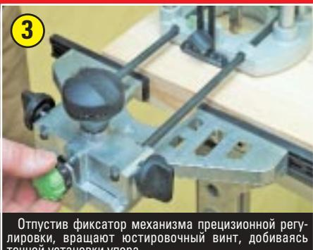
Отпустив фиксатор механизма прецизионной регулировки, вращают юстировочный винт, добиваясь точной установки упора.
