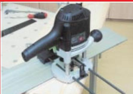
Шину фиксируют относительно заготовки. Фрезер позиционируется по ней при помощи «башмака», аналогичного боковому упору, и может размещаться на разном удалении от нее. Поскольку на шину опирается лишь часть платформы, выдвигают дополнительную «ножку».
