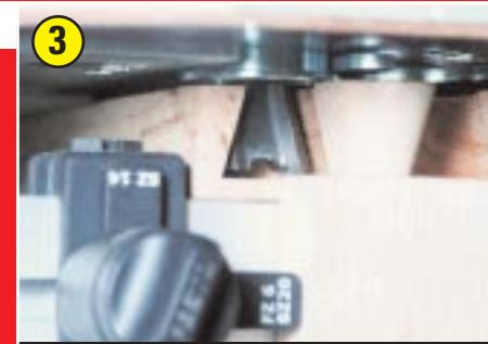
На фрезер устанавливают специальную копировальную втулку. Для повышения точности вертикального позиционирования она имеет бортик на опорном кольце, позволяющий захватить пластину шаблона с двух сторон. Руководствуясь общим правилом ведения инструмента против хода фрезы, заготовку проходят от центра к краю. Предварительно рекомендуется сделать подрезку (протык шаблон по выступам, не «заходя» в них) — это позволит избежать сколов.
