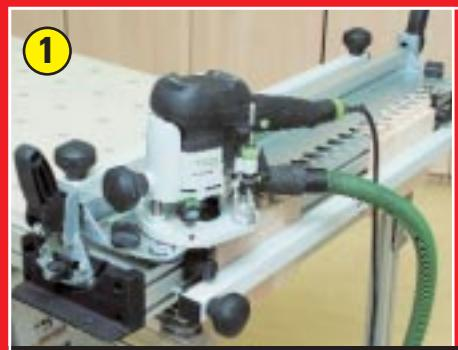
В зависимости от типа шаблона устанавливают фрезу. Регулируя глубину ее погружения, задают плотность соединения. Его можно собрать внатяг или на клей (для него необходимо предусмотреть зазор). С помощью специальных окон в шаблоне задают про-
