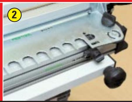
дольное положение упоров заготовки и поворачивают их соответствующей шаблону стороной. Далее с каждой стороны шаблона парами зажимают сопрягаемые детали. Они должны быть чисто обработаны и плотно пригнаны.
