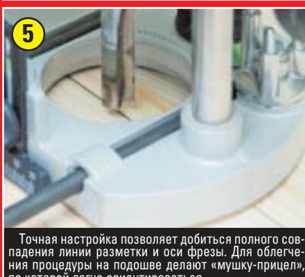
Точная настройка позволяет добиться полного совпадения линии разметки и оси фрезы. Для облегчения процедуры на подошве делают «мушку-прицел», по которой легче ориентироваться.
